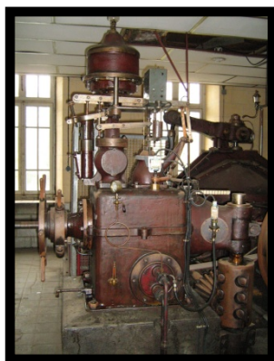
Le régulateur d'une des turbines date des années trente et marchait encore il y a quelques années
